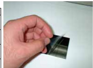
写真8：クリーニングカードの表面の保護シートを剥がします。
