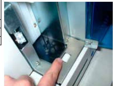
写真9：最初はカード粘着部を上向きにセットし、カードを指で、深く止まるまで押し込んで下さい。6番の動作でカードは挿入されたら、カードの後端をゆびでおして下さい。
